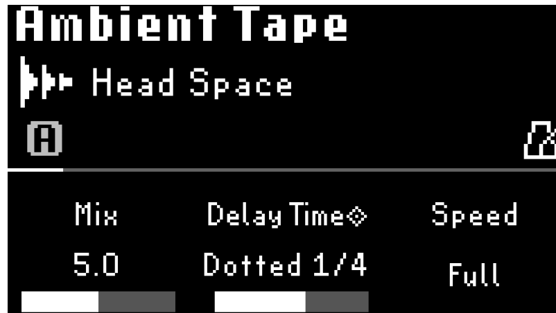
図 6.13 メトロノームのアイコンは、Tempo Syncが有効になっていることを示し、時間ベースのパラメーターは音符のサブディビジョンとして表示されます。
