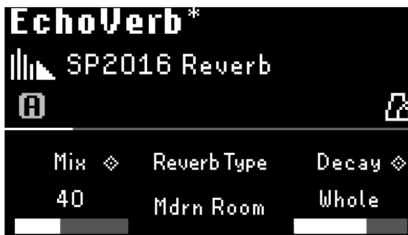
図 6.10 パラメーターが外部コントローラーまたはHotKnobにマッピングされている場合、パラメーター名の横にダイヤモンドのマークが表示されます。
