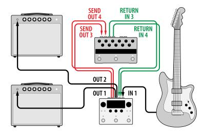
Fig. 3.4 One Stereo Insert
